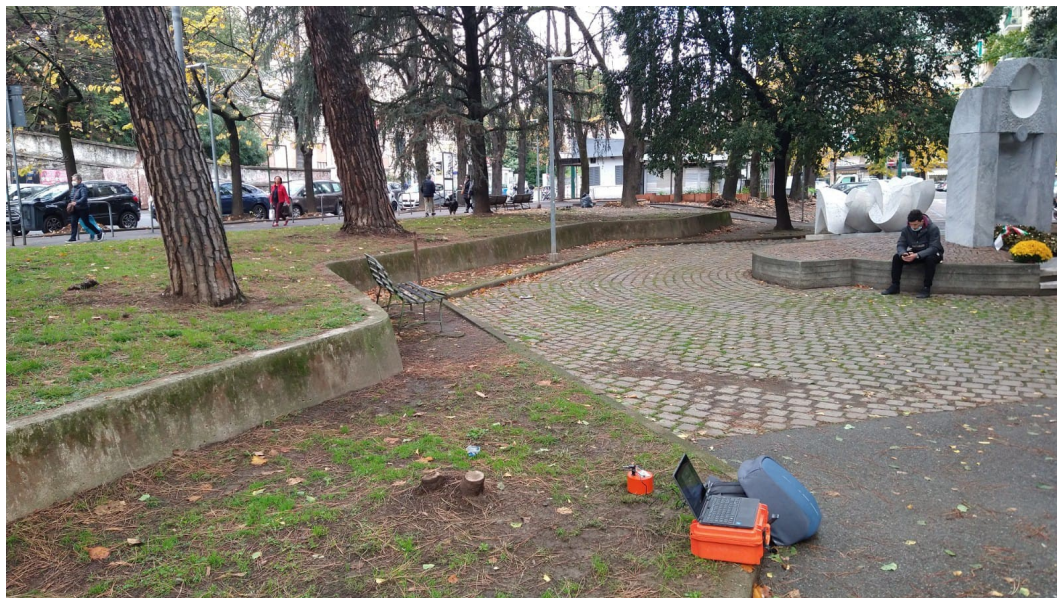
Foto n. 6_ Fase di registrazione del rumore sismico di fonda durante l'esecuzione della prova HVSR1
