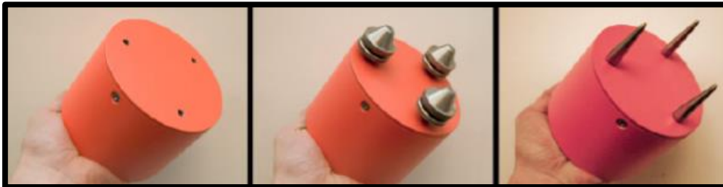
Figura A. 6a - Versione “GEMINI HVSr” basilare impiegata per la prospezione sismica passiva: dettaglio dei supporti intercambiabili in dotazione, da sostituire a seconda che si acquisisca su superficie rigida o su terreno.
