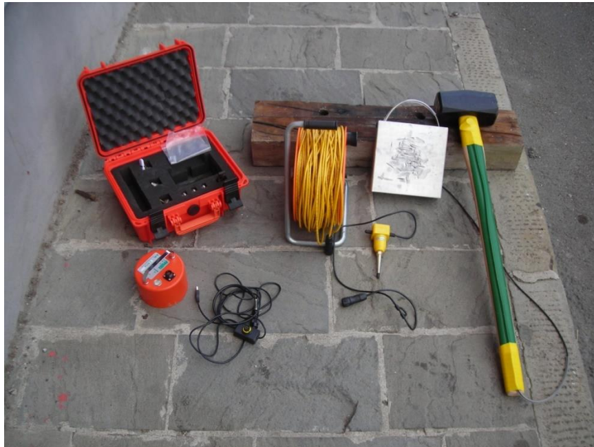
Figura A. 6b - Versione “GEMINI MASW” impiegata per la prospezione sismica attiva: lo stendimento prevede il collegamento della strumentazione procedendo da sinistra verso destra. In aggiunta va inserito il PC come per una normale acquisizione HVSr.
