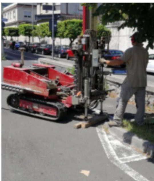
Foto n. 4_ esecuzione prova penetrometrica dinamica
