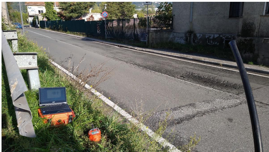
Figura A. 2 - Acquisizione HVSr2 realizzata in corrispondenza dell'area di studio.
