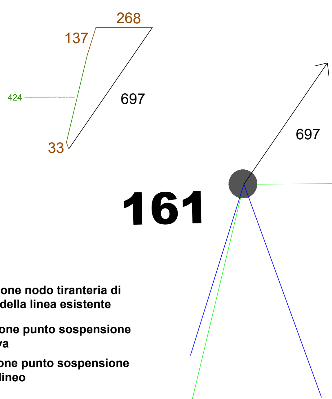
DETERMINAZIONE GRAFICA SOLLECITAZIONI TRASMESSE SU PALI DI SOSTEGNO DAL FILO DI LAVORO (10 mm = 100 Kg forza)
